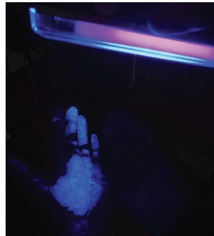
Hanskene som har vært i kontakt med UV-pulveret lyser blått når de blir belyst med ei UV-lampe. Foto: Berit Reitan
