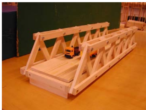
Figur 3.14 Fagverksbro i tre (Modellbyggesett) (Foto JJJ)
