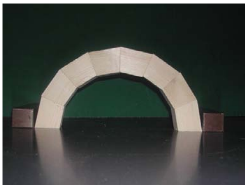
Figur 3.9 ”Ekte” buer bygget av 8 hhv 50 ”byggstein” (Foto JJJ)
