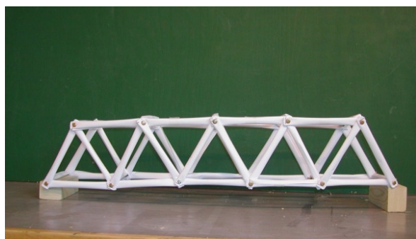
Figur 3.11 Fagverksbro i papir (Foto JJJ)
