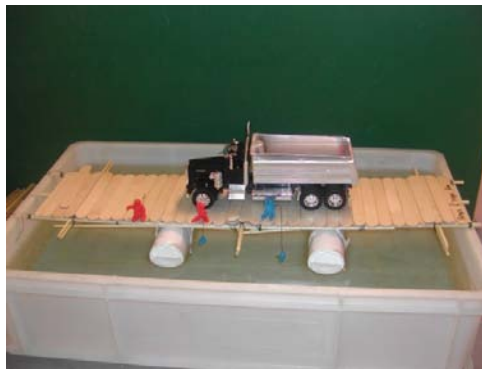
Figur 3.15 Modell av flytebro (foto JJJ)
