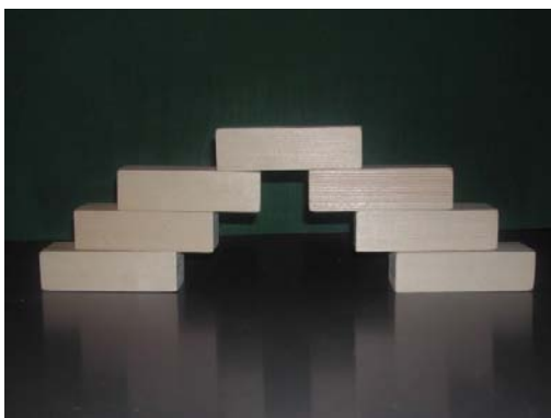
Figur 3.8 Uekte bue av treklosser (Foto JJJ)
