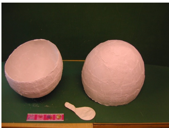
Figur 3.22 Skall laget på ”ballongstillas” (Foto JJJ)
