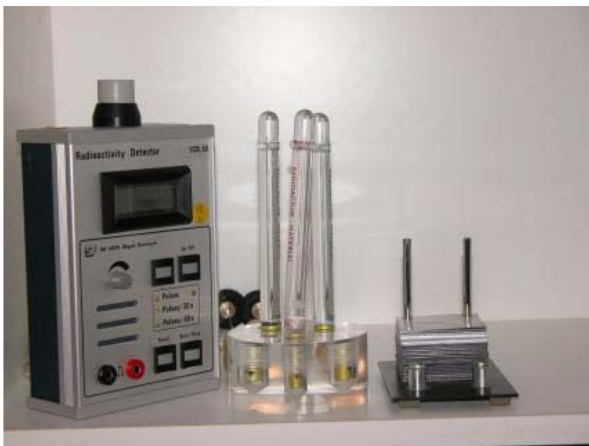
Figur 15 Geigerteller og kapslete radioaktive kilder
